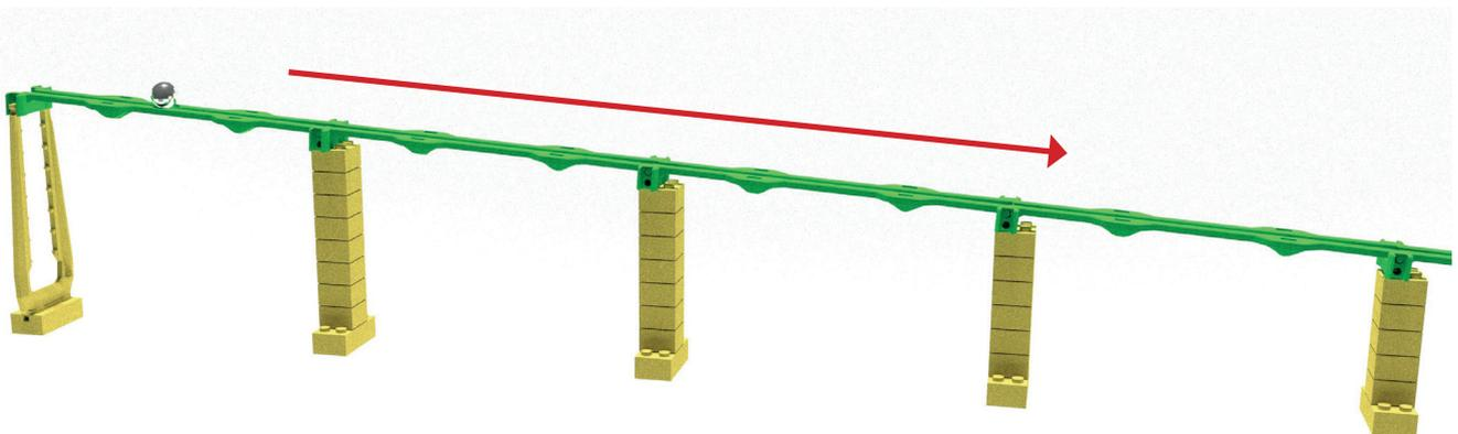
Damit die Kugel rollt muss das Gefälle von hoch zu tief sein. Dies wird mit der Anzahl der Klemmbausteine bestimmt, oder mit dem justieren der Höhe im Rolli-Coaster Pfosten.
